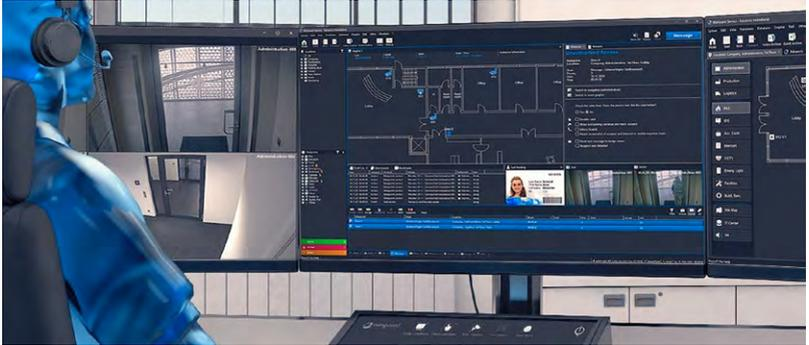
Die intelligente Analyse von Meldungen verschiedener Sensoren aus unterschiedlichen Zonen des Perimeters oder des Betriebsgeländes reduziert Täuschungsalarme und ermöglicht dem Sicherheitspersonal, sich auf qualifizierte Alarmer zu konzentrieren. Dabei hilft die Zusammenführung aller Meldungen in einem Gefahrenmanagementsystem und deren Visualisierung im Lageplan, schnell und gezielt zu reagieren.
